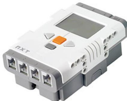
Figura 3 - NXT, o cérebro do robô (MINDSTORMS, 2008).
