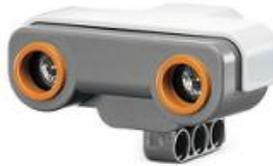
Figura 7 - Sensor Ultra-Sônico (MINDSTORMS, 2008).
